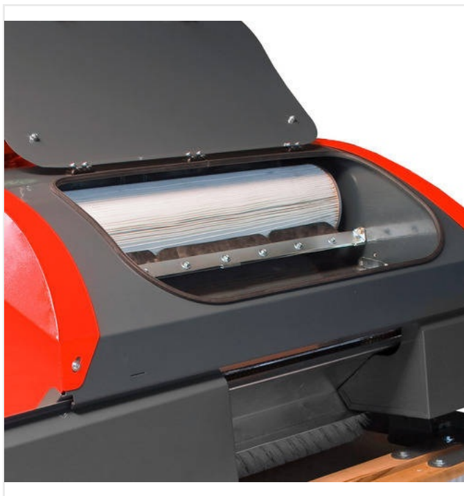
Filtro permanente con autolimpieza continua
