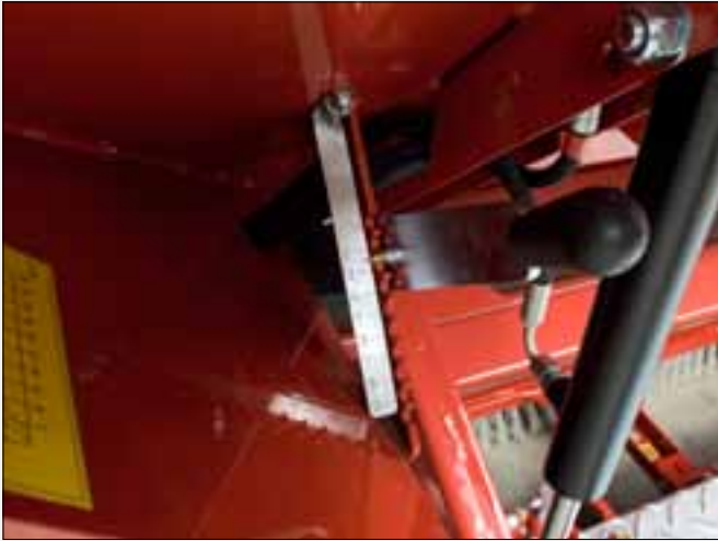
Salida de material regulable con exactitud mediante palanca
