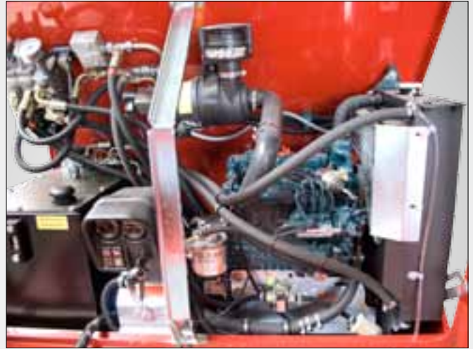
Motor Kubota diesel, 3 cilindros refrigerado por agua
