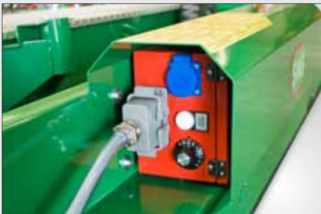
Plancha calefactable con termostato y conexión supletoria eléctrica de 220 V
