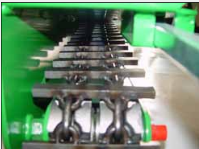
Cadena extra ancha (140 mm) para su uso sobre casi cualquier superficie
