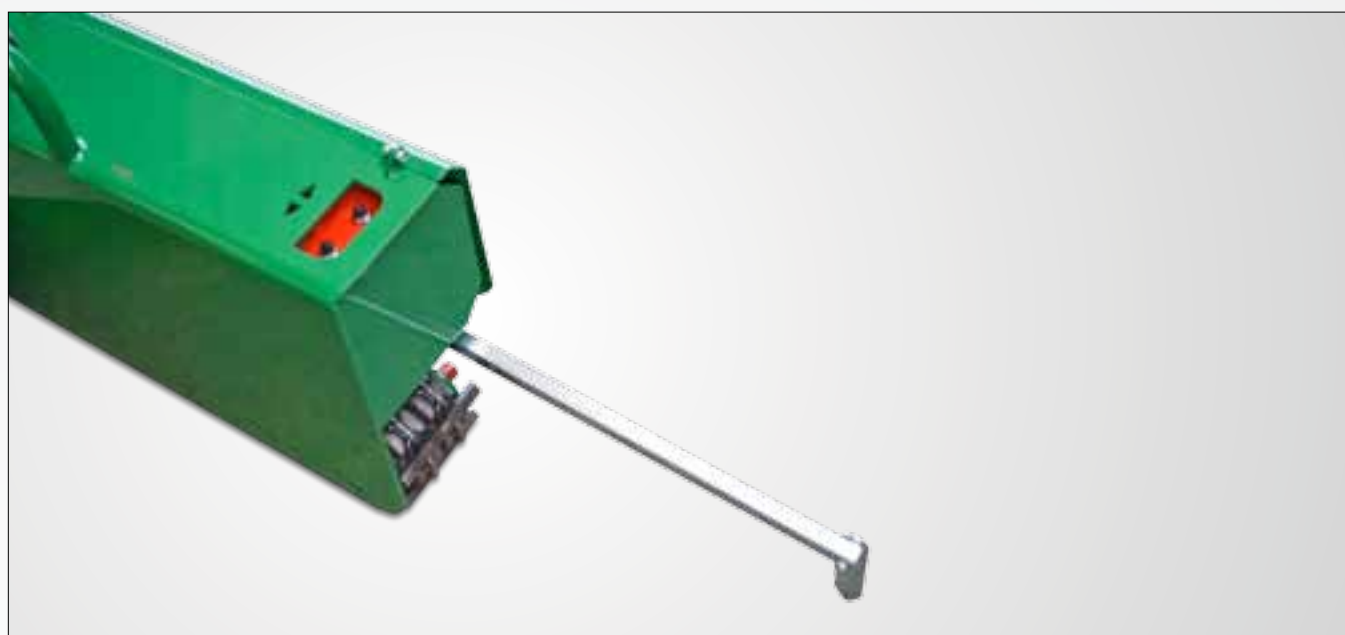
Teclado adicional para la conducción de la máquina desde el frente, en ambos lados
