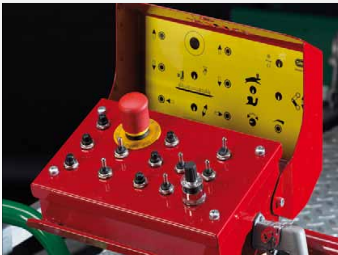
El panel de mandos en ambos lados incorpora muchas funciones incluido el dispositivo de gestión automática de curvas (928/P936)
