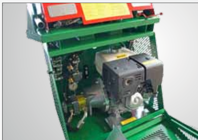
Motor de gasolina y elementos de control, protegidos y ordenados claramente
